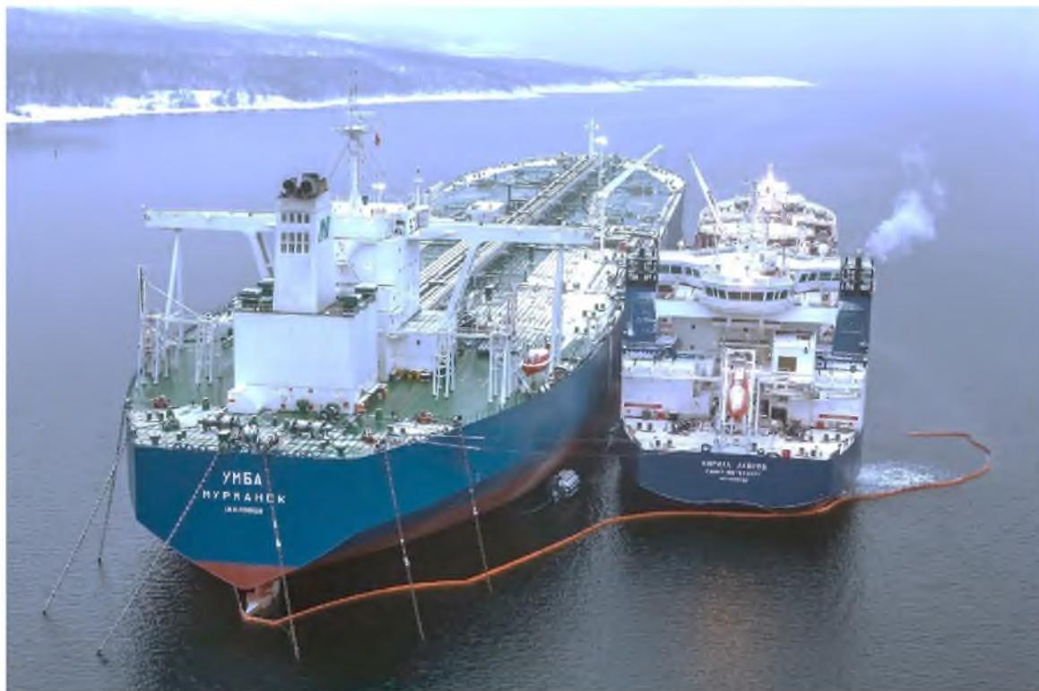
Рисунок 7 – Перегрузка арктической нефти с челночного танкера «Кирилл Лавров» на танкер-накопитель «Умба»
