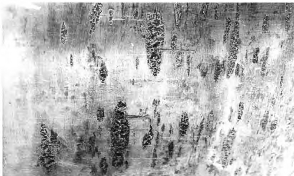
Рисунок 4 – Фреттинг-коррозия на поверхности конуса гребного вала с глубиной до 2,5 мм т/х «Пионер Владивостока» (типа «Сестрорецк»), видны следы сдвига металла после разобращения конусного соединения взрывом)
