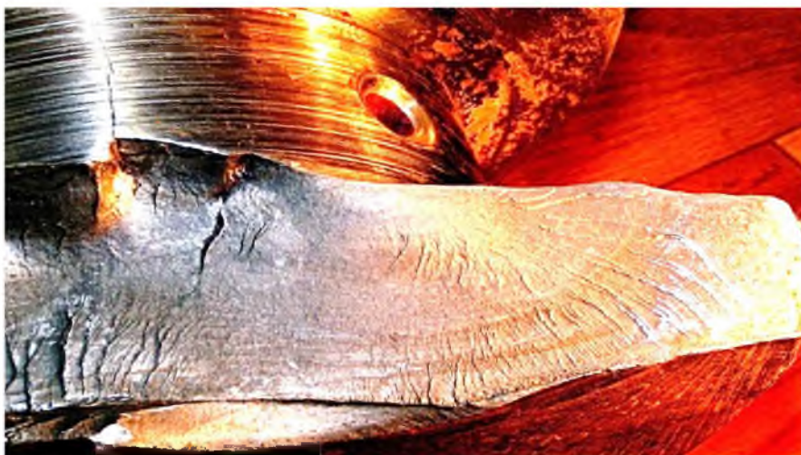
Рисунок 8 – Фрагмент излома на рисунке 7. Трещина по образующей шейки – вершина трещины по щеке
