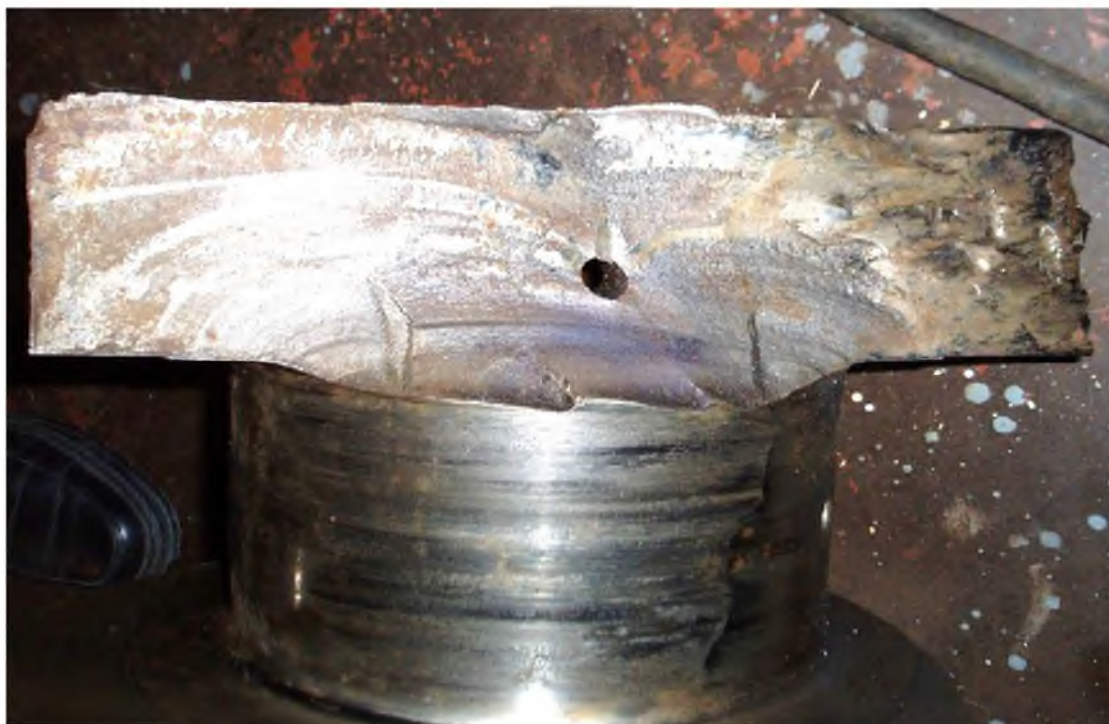
Рисунок 1 – Излом коленчатого вала дизеля 68Г-6 т/х «Алагеэ»
