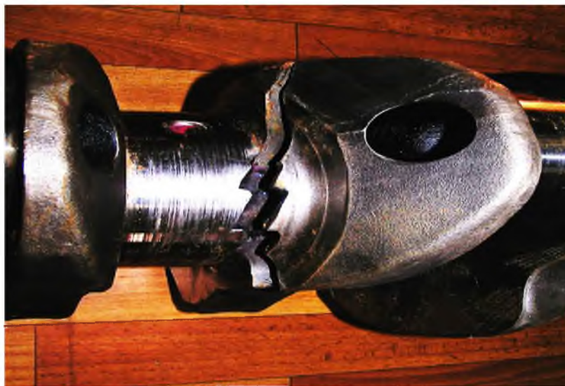
Рисунок 7 – Расположение поверхностей излома по 4-й рамовой шейке коленчатого вала дизеля вспомогательного дизеля типа S6B-MPTK
