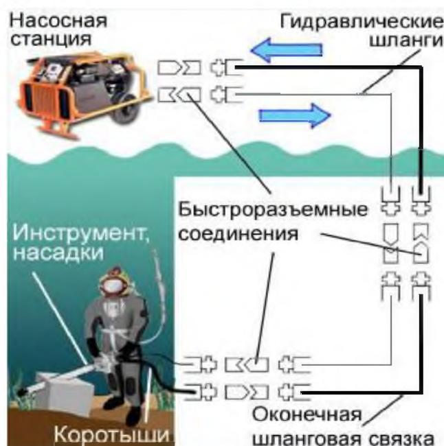
Рисунок 1 – Типовая схема гидравлических систем привода водолазного инструмента
