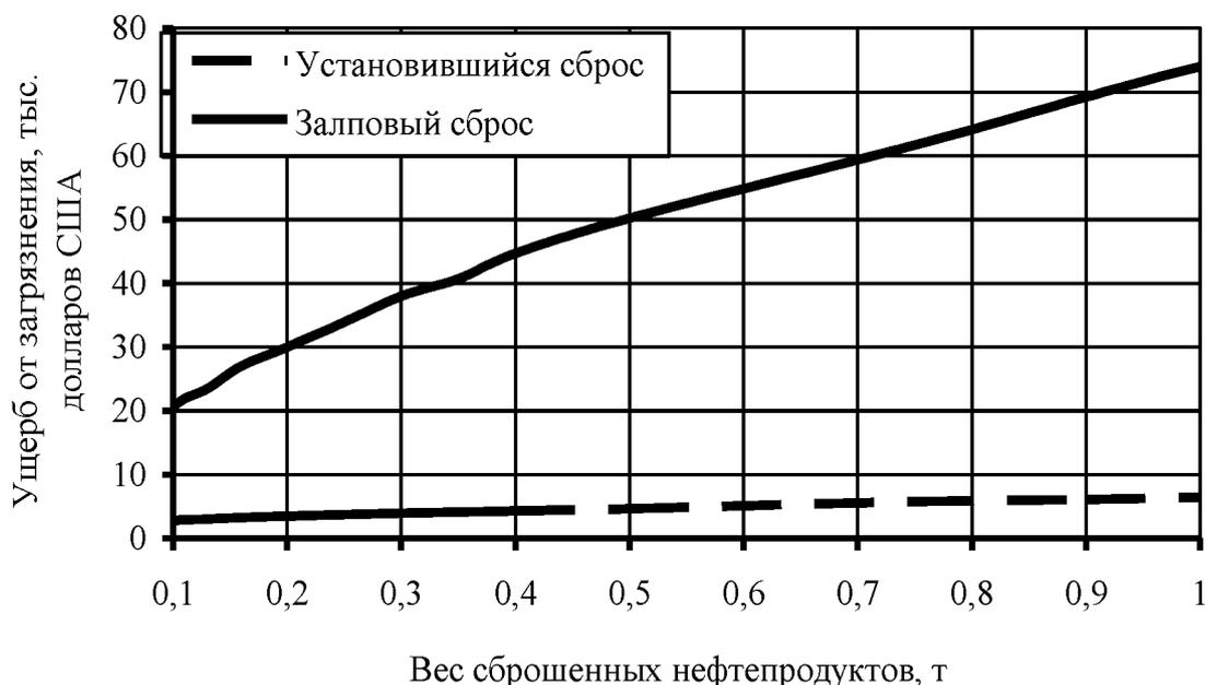
Рисунок 4 – затраты на устранение последствий аварий и компенсации ущерба
