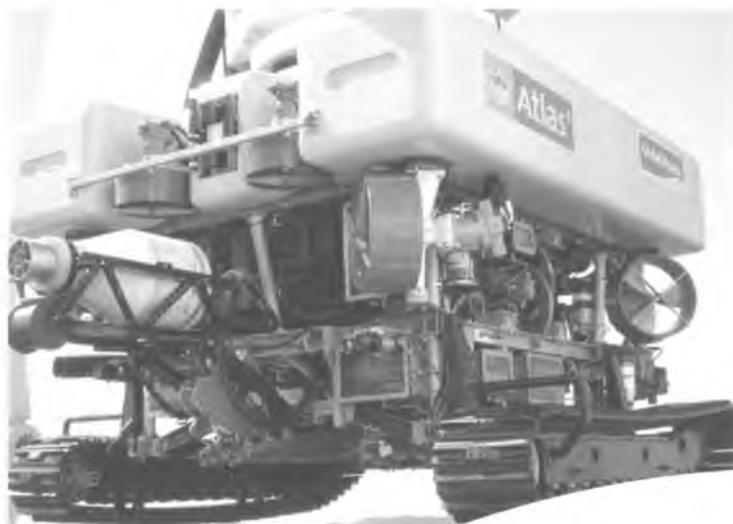
Рисунок 3 – Подводные инженерные машины «SMD-Hidrovision»
