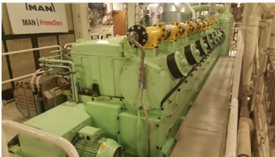
Рисунок 6 - Главный двигатель MAN 8L51/60DF мощностью 7800 кВт с возможностью работы на газе
