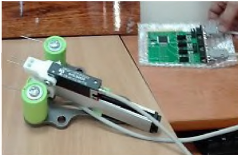
Рисунок 11 – Первоначальный опытный макет измерительной головки устройства с датчиками линейных и угловых перемещений сопряженными с платой обработки информации
