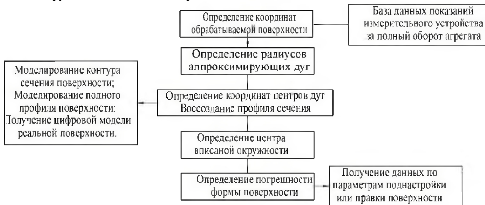
Рисунок 4 – Схема процесса определения геометрических параметров крупногабаритной детали с нестационарной осью вращения
