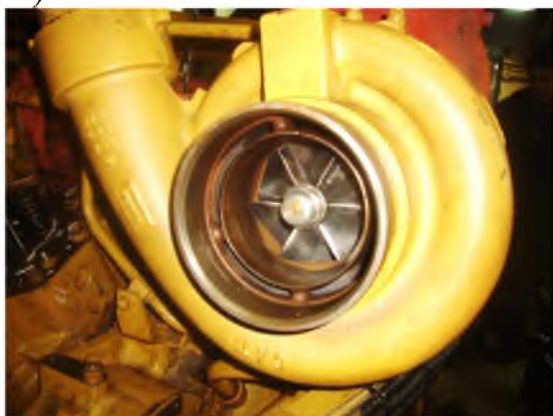
Рисунок 3 – Фото улитки и рабочего колеса компрессора турбокомпрессора а) до аварии; б) после аварии
