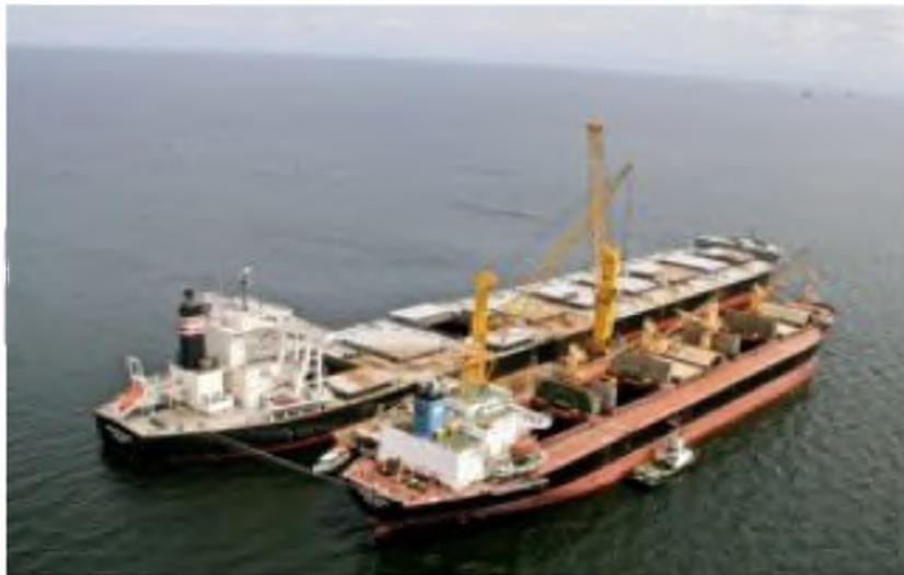
Рисунок 2 – Процесс лихтеровки балкеров
