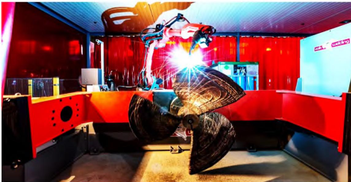
Рисунок 2 – Процесс печати на 3D-принтере судового гребного винта
