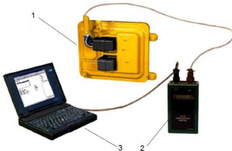
Рисунок 3 – Общий вид диагностического оборудования МАИС: 1 – АИС; 2 – АЦП; 3 – ПК
