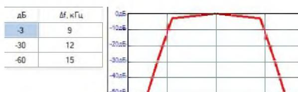
Рисунок 5 – АЧХ фильтра приемника (усилителя промежуточной частоты (УПЧ)) «Транзас» СКБВ 468925.101.1
