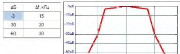
Рисунок 6 – АЧХ фильтра УПЧ приемника МХ800
