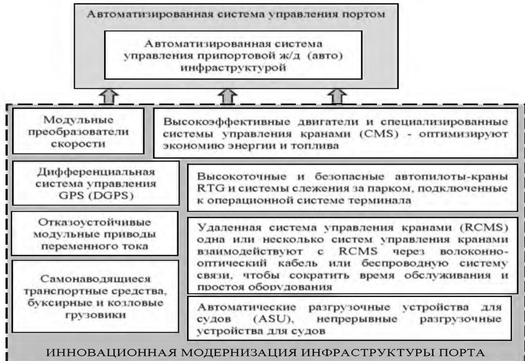
Рисунок 7 – Схема модернизации портовой инфраструктуры для последующего формирования системы «АСУ в АСУ» (разработан автором)
