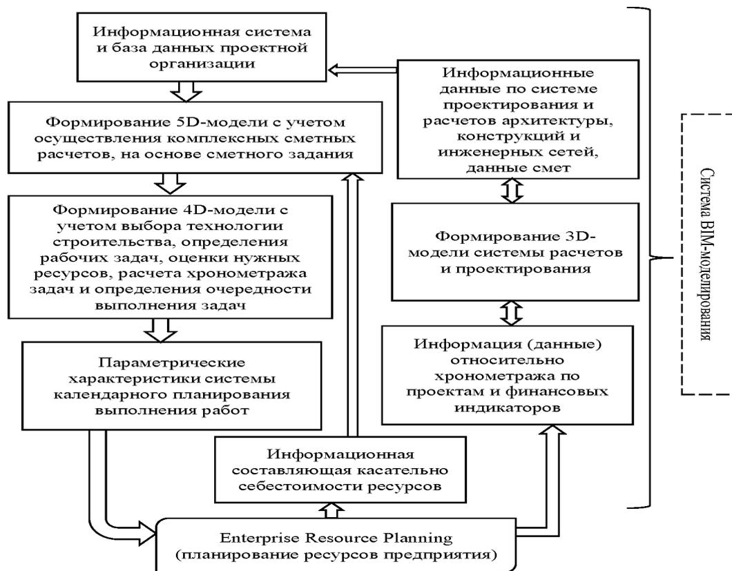
Рисунок 4 – Интеграция системы ERP и BIM-моделирования при разработке проектов по синхронизации инфраструктуры морского и ж/д транспорта (составлен автором по материалам источника [5])
