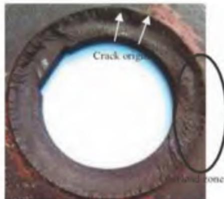
Рисунок 4 – Места возникновения множественных усталостных трещин на фланцевой части муфты вала
