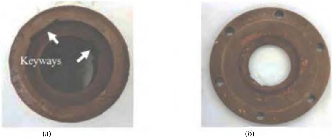
Рисунок 3 – Муфта вала в разобранном виде на цилиндрическую (а) и фланцевую (б) части
