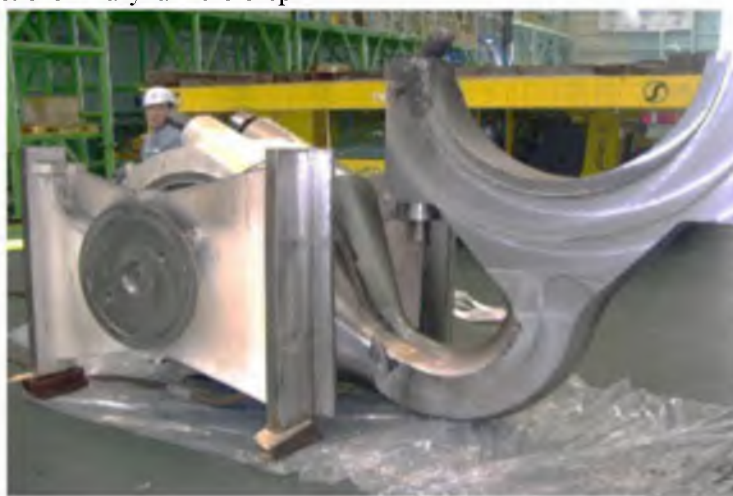
Рисунок 3 – Повреждение (аварийное) шатуна с изгибом стержня
