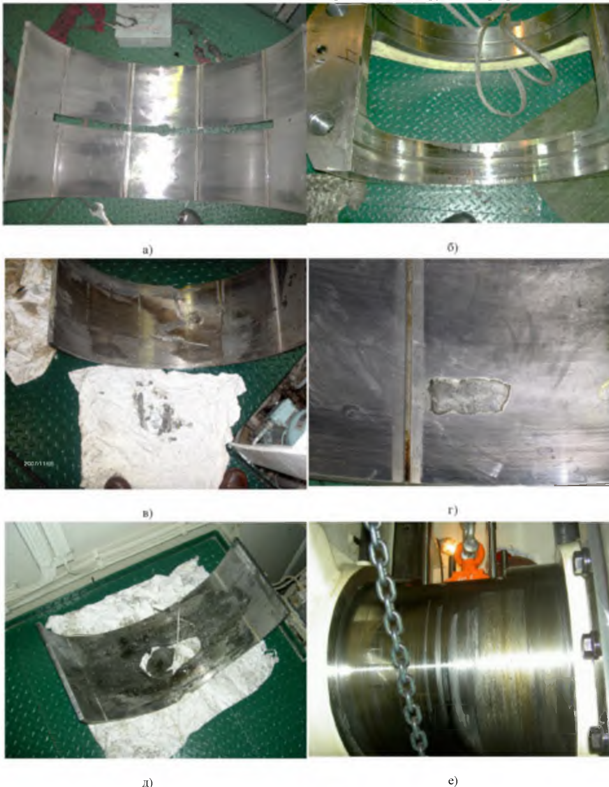
Рисунок 8 – Фото вкладышей кривокопфного подшипника с характерными дефектами: а) нижний вкладыш, б) верхний вкладыш, в) и г) отслаивание и выкрашивание антифрикционного слоя соответственно, д) прогар вкладыша, е) задиры цапфы поперечины
