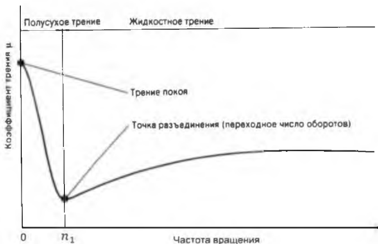
Рисунок 4 – График зависимости коэффициента трения в подшипнике от числа оборотов (при постоянной нагрузке)
