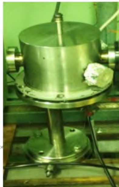
Рисунок 1 – Конструкция и внешний вид установки для исследования физико-технических характеристик полупроводников, диэлектриков и электроизоляционных материалов
