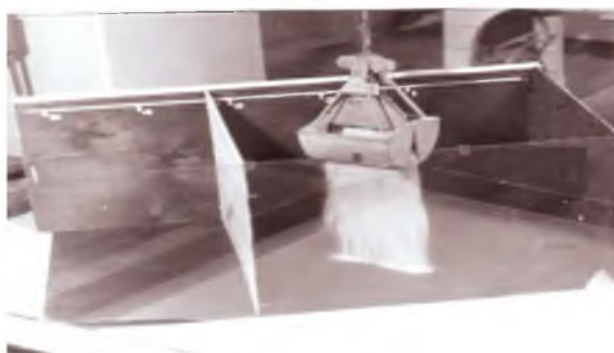
Рисунок 5 – Установка для исследования потерь груза от пылеобразования: 1 – стенка задняя со шкалой; 2 – стенка боковая неподвижная; 3 – стенка переносная; 4 – стенка передняя прозрачная
