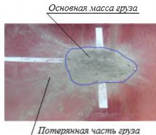
Рисунок 3 – Определение потерянной части груза от пылеобразования при разгрузке грейфера
