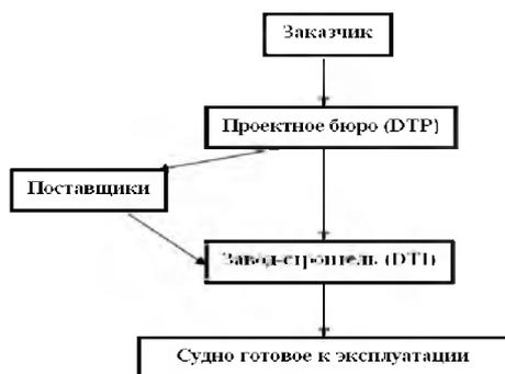
Рисунок 1 – Схема процесса строительства судов
