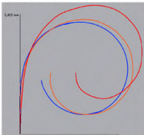
Рисунок 4 – Циркуляция контейнеровоза при ветре с направления 0 градусов и скорости ветра
