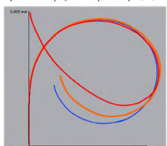
Рисунок 5 – Циркуляция контейнеровоза при ветре с направления 90 градусов и скорости ветра 0, 10, 20 м/с
