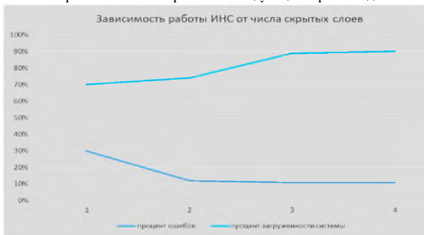
Рисунок 5 – Сравнение точности работы и нагрузки на систему ИНС при увеличении числа скрытых слоев
