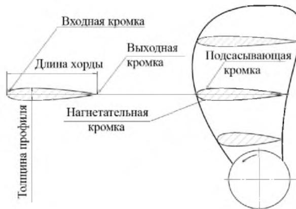
Рисунок 1 – Профилирование лопастей гребного винта фиксированного шага
