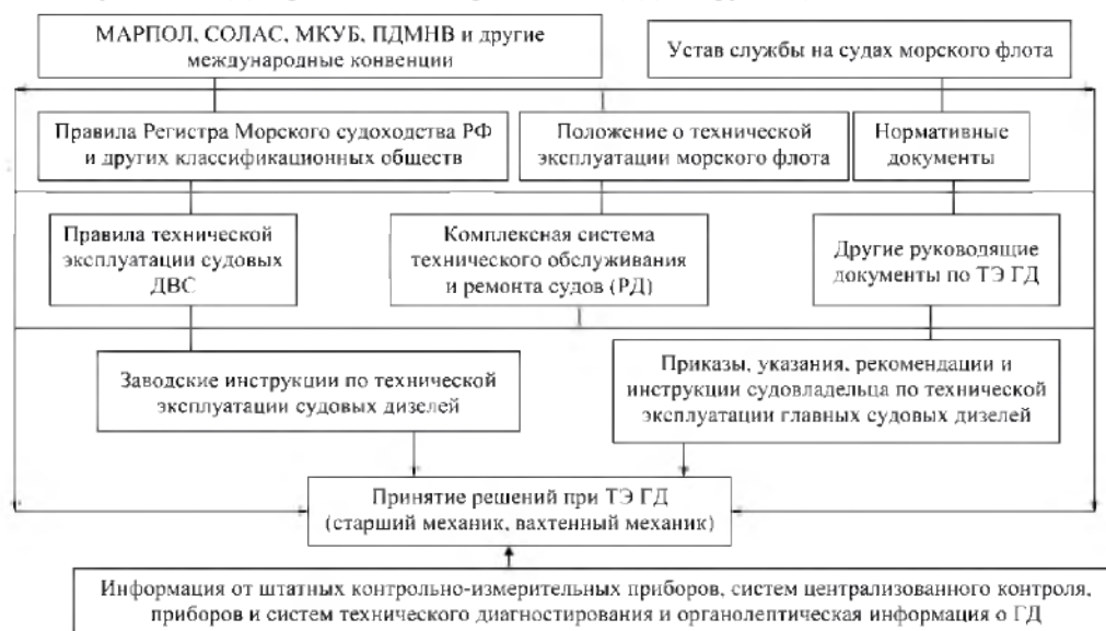
Рисунок 2 – Структурная схема информационной базы технической эксплуатации главных судовых дизелей
