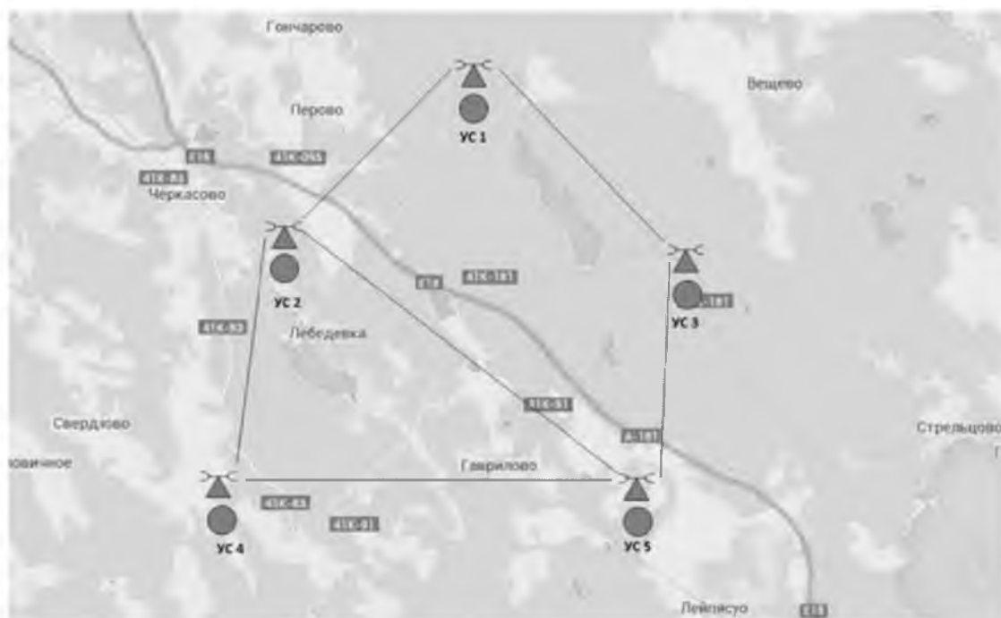
Рисунок 1 – Вариант построения радиорелейной сети связи, образованной радиорелейными станциями Р-416ГМ
