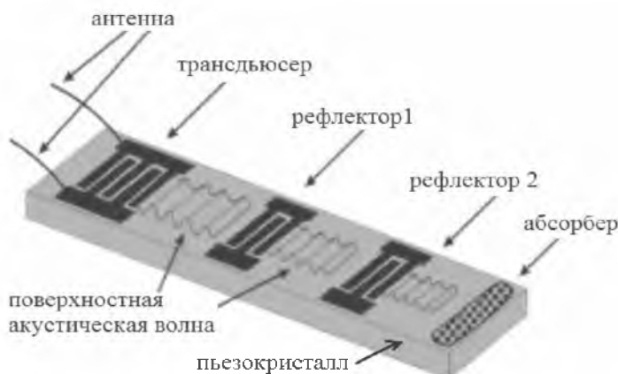
Рисунок 9 – Чувствительный элемент датчика системы SENTRY GB100
