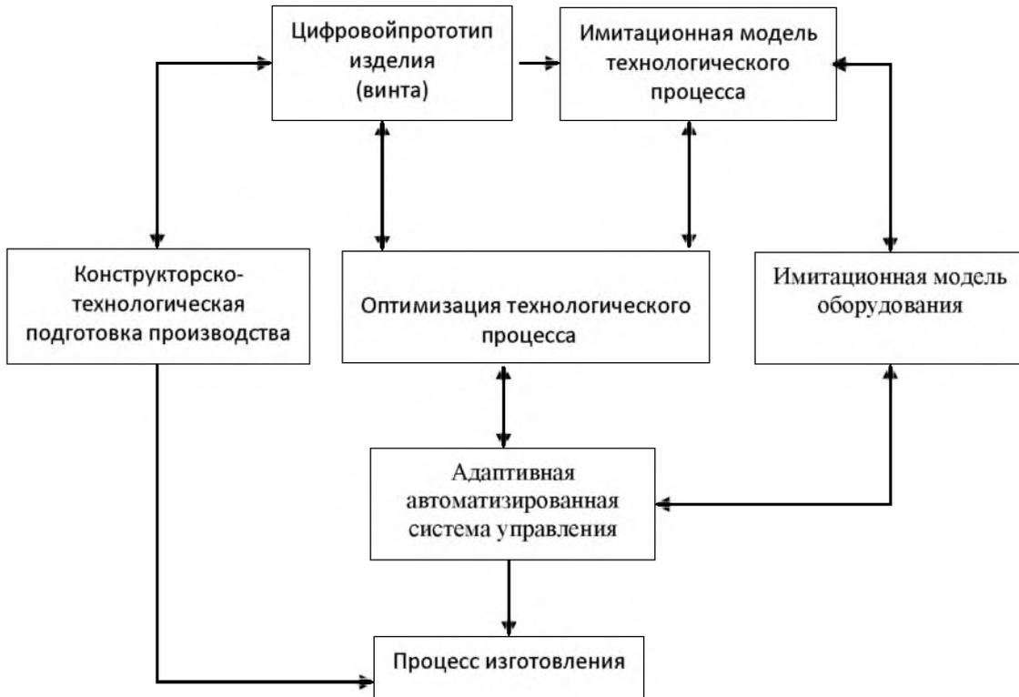
Рисунок 1 – Система взаимосвязи цифрового моделирования и конструкторско-технологической подготовки производства
