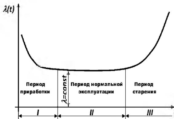
Рисунок 1 - Зависимость частоты и интенсивности отказов от времени
