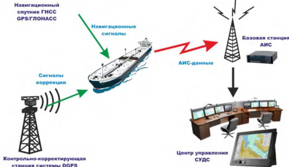
Рисунок 1 – Общий принцип функционирования автоматической идентификационной системы
