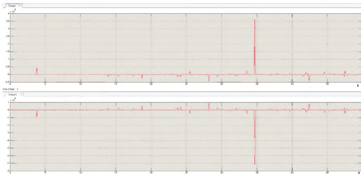
Рисунок 6 – График погрешности, возникающий в модели ввиду недостаточной идентификации параметра вектора состояния судна
