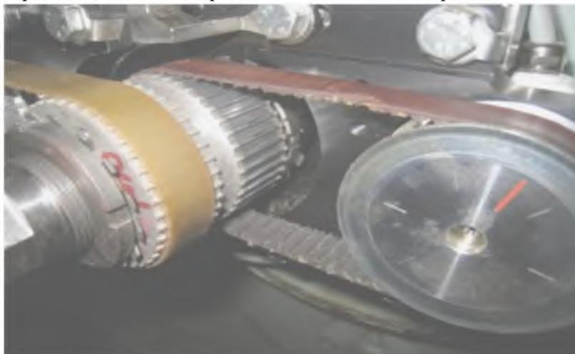
Рисунок 5 – Ремни тахо-системы МОД серии RT-flex (замена через 2-3 года)
