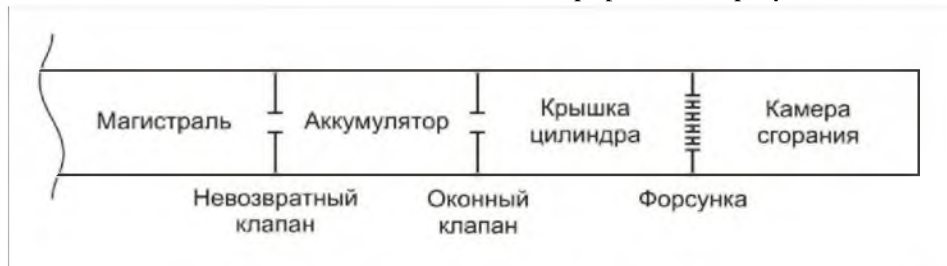
Рисунок 1 – Схематическое представление состава газовой топливной системы МОД
