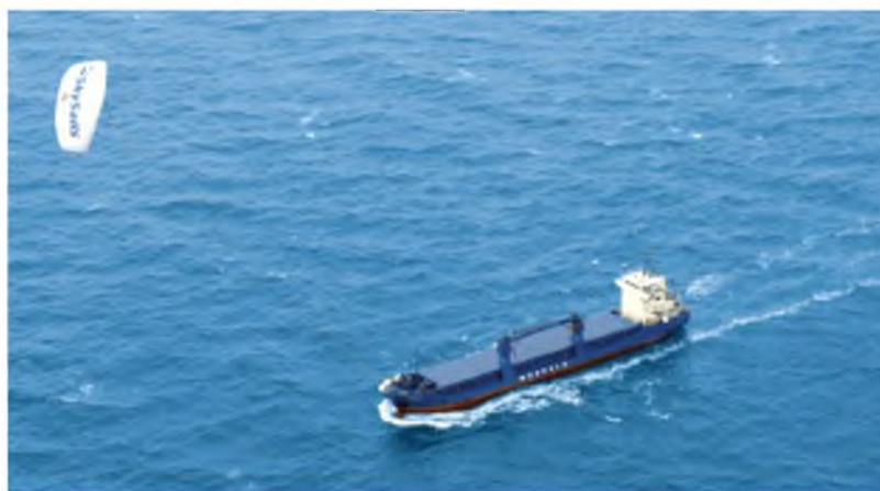
Рисунок 2 – Пример использования кайта для помощи движению судну
