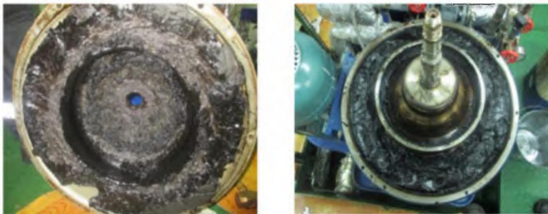
Рисунок 1 – Отказ сепаратора тяжелого топлива, ввиду низкокачественной поставки топлива
