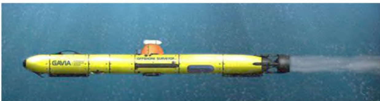
Рисунок 2 – Автономный обитаемый подводный аппарат «Gavia»
