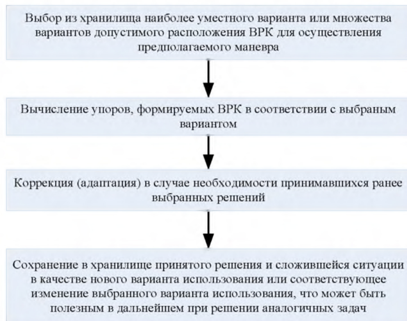
Рисунок 3 – Процесс функционирования интеллектуальной системы управления
