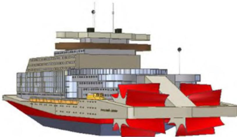
Рисунок 1 – Ледокольно-пассажирское колёсное судно ледофрез «Русский север»
