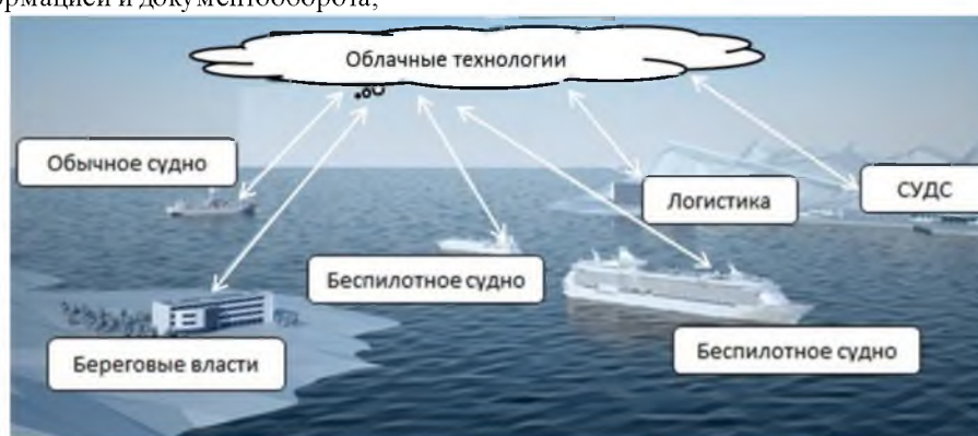
Рисунок 2 – Схема взаимодействия блоков инфраструктуры е-Навигации с помощью облачных технологий
