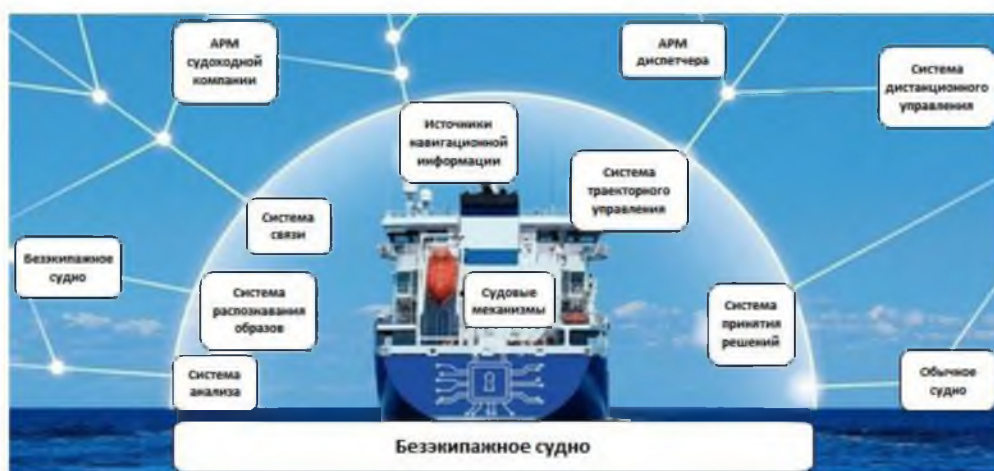
Рисунок 4 – Вариант принципиальной схемы систем управления безэкипажного судна
