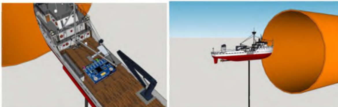
Рисунок 8 – Общий вид аэродинамических весов с исследуемой моделью и размещенным датчиком
